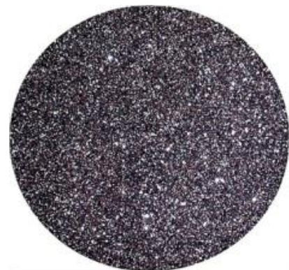
Obr. 22 Struktura taveného tavidla [26]
