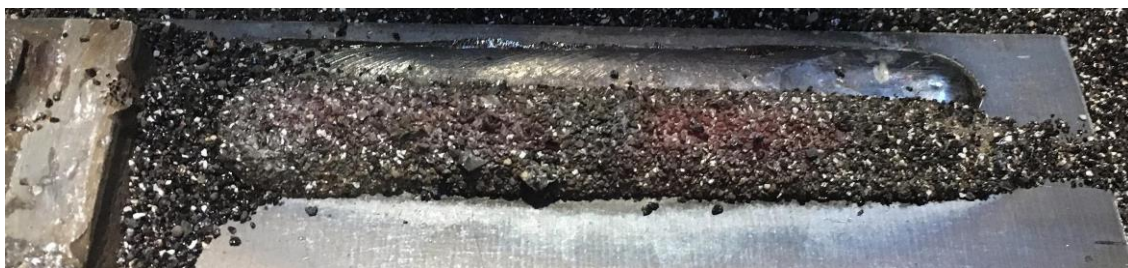
Obr. 27 Svarová housenka s ochranným struskovým krytem (nelegované tavidlo)
