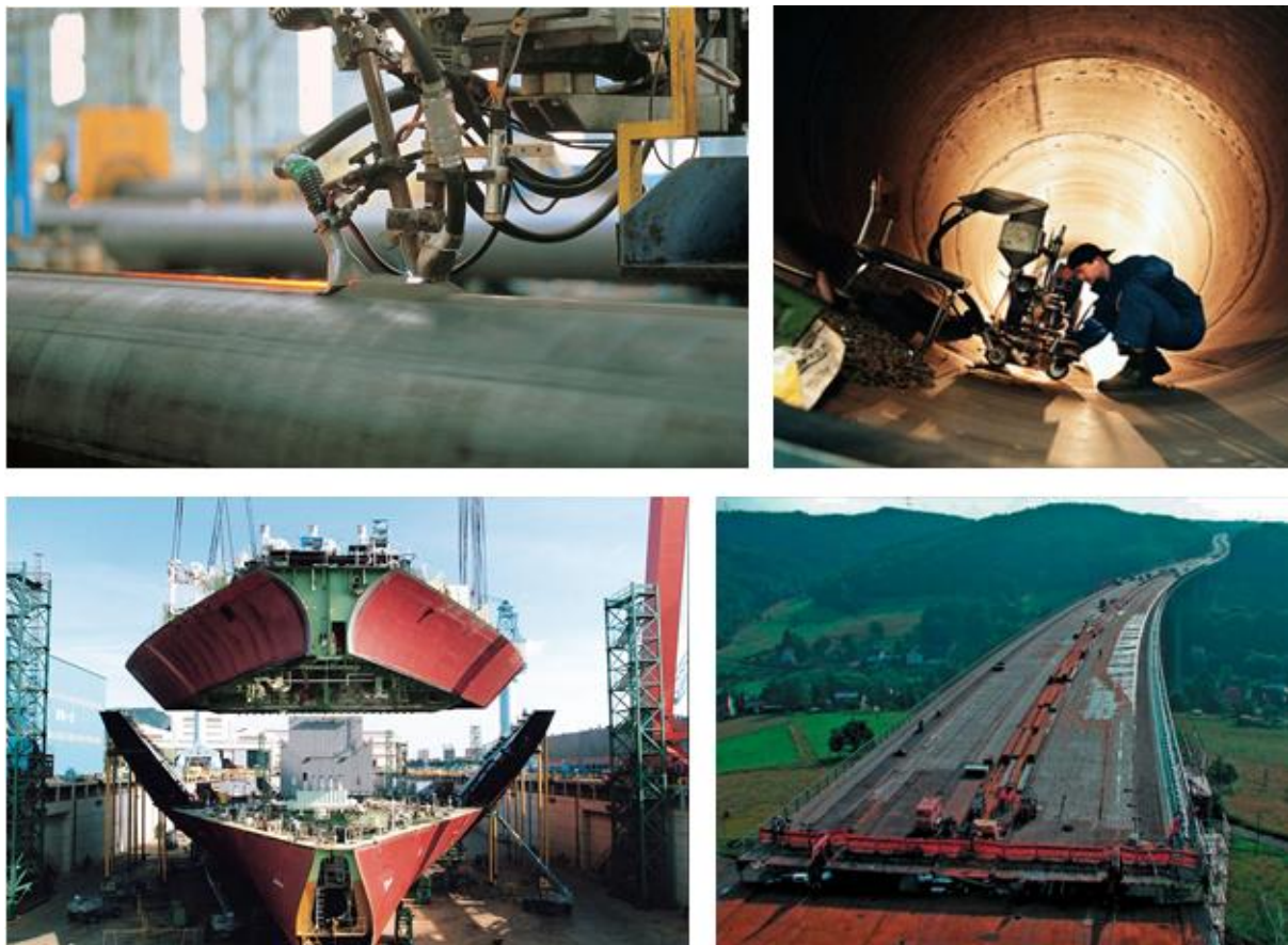
Obr. 1 Aplikace svařování pod tavidlem a oblasti využití [4], [5]
