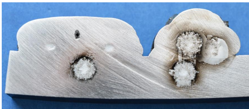
Obr. 30 Vzorek po zkoušce chemického složení
