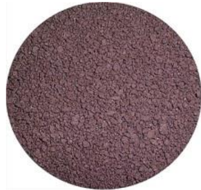
Obr. 23 Struktura aglomerovaného tavidla [26]
