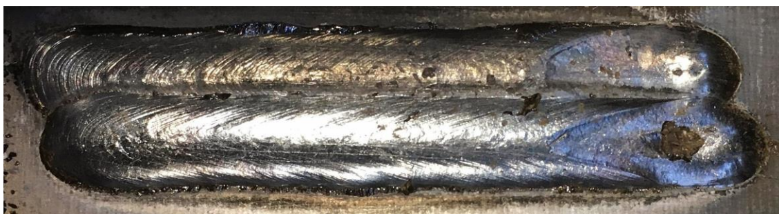
Obr. 29 Svarové housenky s odstraněnou struskou (nelegované tavidlo)
