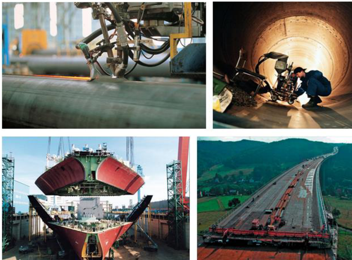
Obr. 1 Aplikace svařování pod tavidlem a oblasti využití [4], [5]
