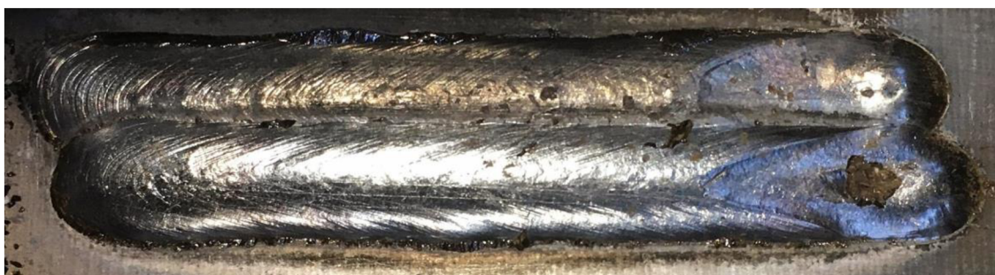
Obr. 29 Svarové housenky s odstraněnou struskou (nelegované tavidlo)
