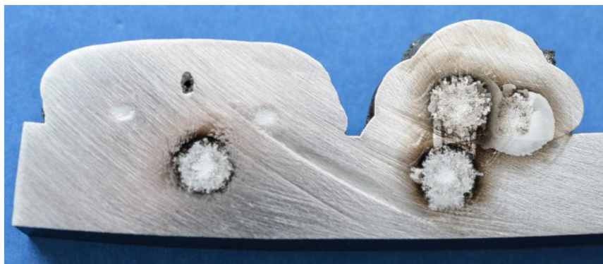
Obr. 30 Vzorek po zkoušce chemického složení
