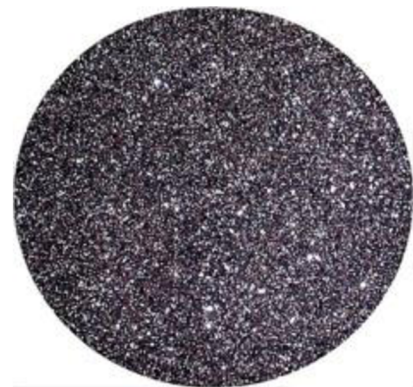
Obr. 22 Struktura taveného tavidla [26]
