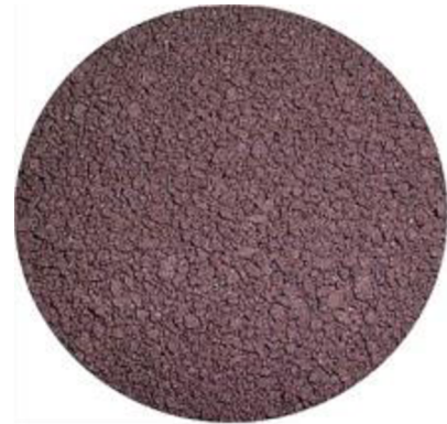
Obr. 23 Struktura aglomerovaného tavidla [26]
