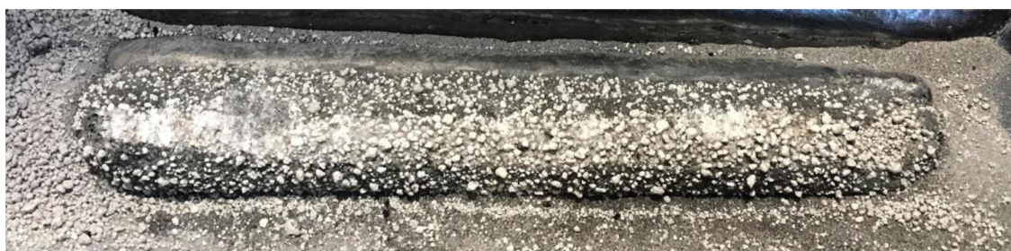
Obr. 28 Svarová housenka s ochranným struskovým krytem (dolegované tavidlo)
