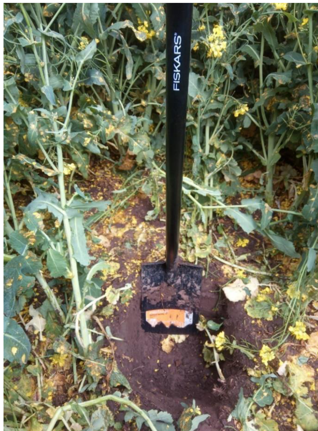
Obrázek 16: Půdní sonda ve tvaru čtverce o rozměrech 32 \times 32 \times 25 cm (foto: Eliška Brandová, 2021)
