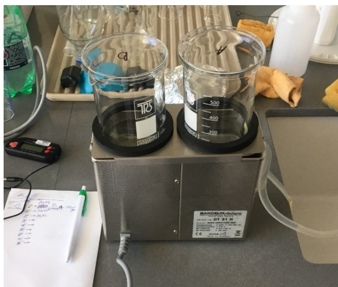
Obr. 14 Na levé straně přístroje je přivedena chladicí hadička. Foto: autorka.
