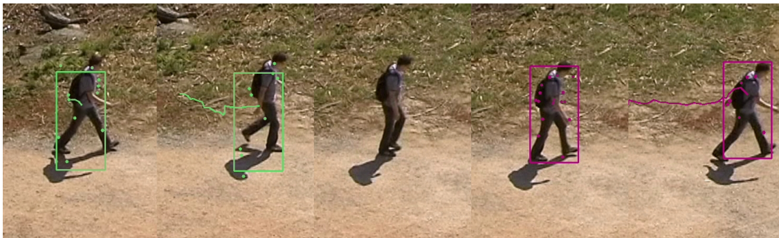
Obrázek 6.3: Ztráta význačných bodů. Chyba trackeru.
