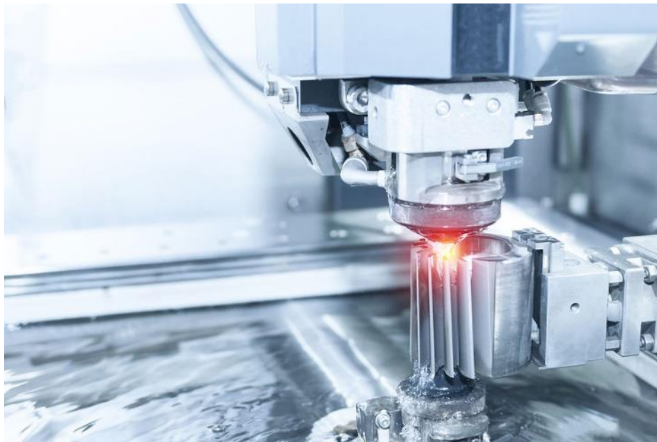
Obr. 4 Ukázka řezání drátovou elektrodou [14].
