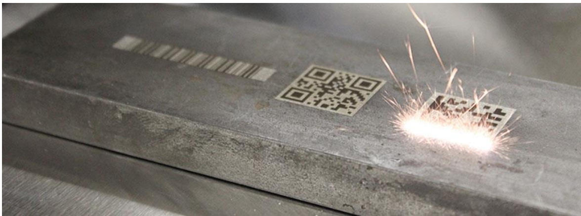
Obr. 1 Ukázka značení laserem [3].
