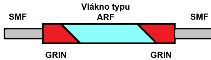
Obr. 3.3: ARF napojené na SMF skrze GRIN [40]
