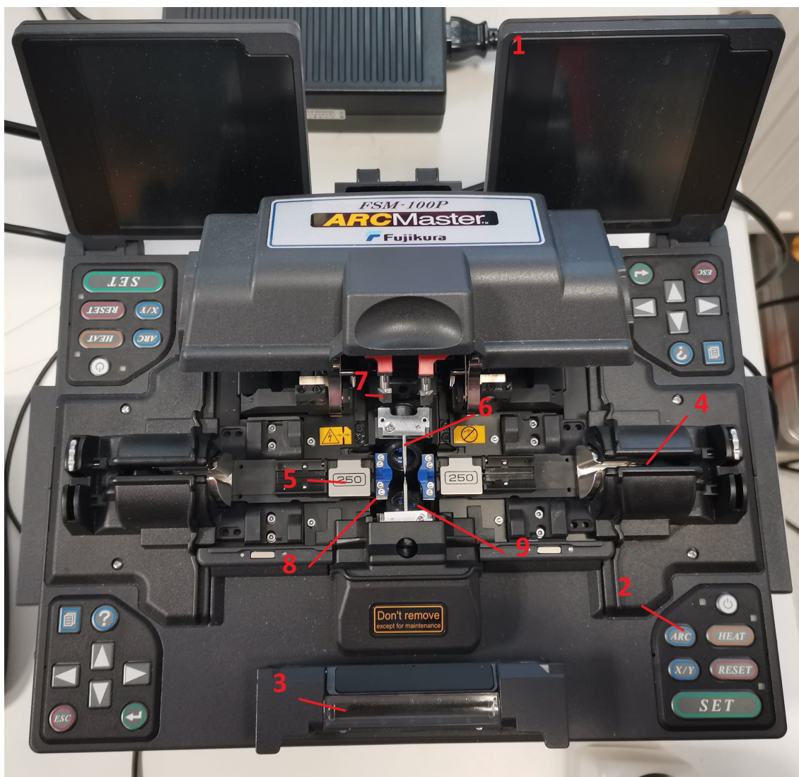
Obr. 5.1: Svářecí automat Fujikura FSM-100P
