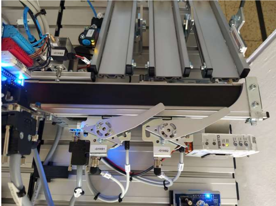
Obrázek 11: Dopravníkový pás s deflektory, které umisťují obrobky do skluzů. Zdroj: vlastní
