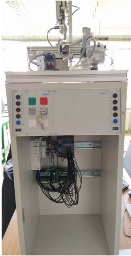
Obrázek 3: Stanice se zapojeným ovládacím panelem Zdroj: vlastní
