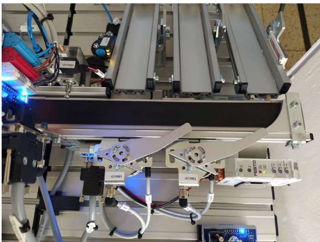
Obrázek 11: Dopravníkový pás s deflektory, které umísťují obrobky do skluzů. Zdroj: vlastní
