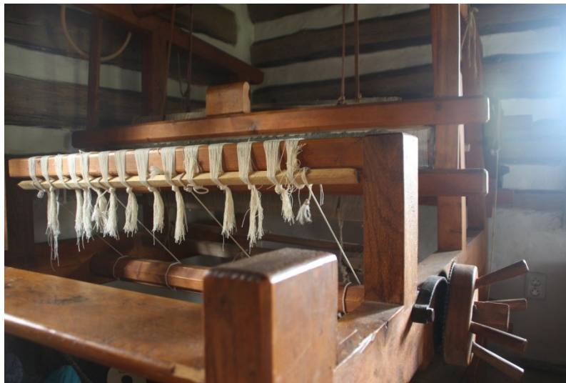
Obr. 11: Prsník a zbožové vratidlo
