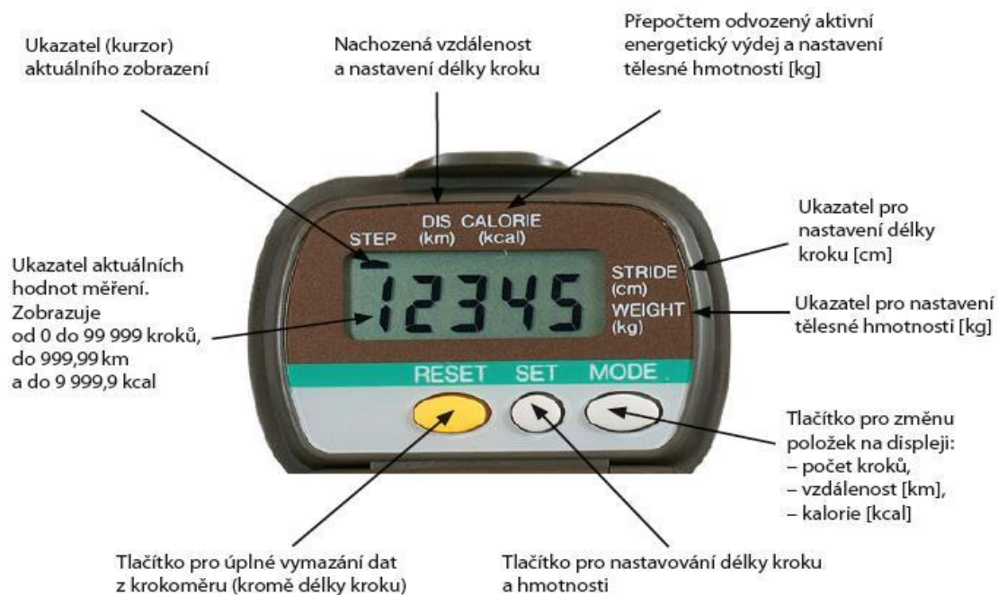
Obrázek 3. Displej pedometru Yamax DigiWalker SW-700 s popisem ovládacích prvků (Sigmund & Sigmundová, 2011).
