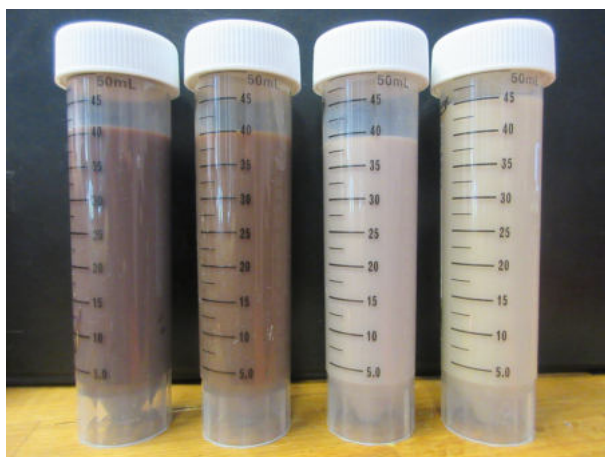
Obr. 4.2: Roztoky Ali 5.1 a 5.2 po cca měsíčním stárnutí (sol z BUTTi vlevo, sol z IPTi vpravo)
