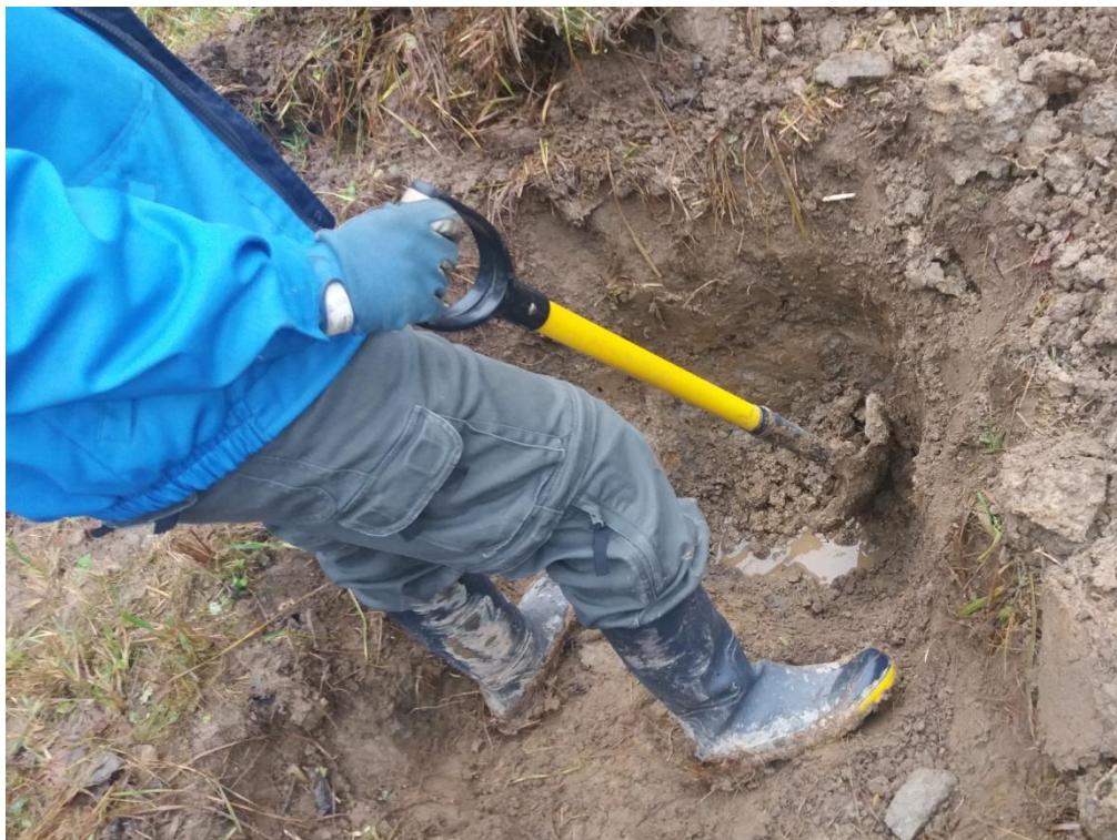
Fotografie č.4: Výkop půdní sondy 1 pro odběr vzorků zeminy na lokalitě II
