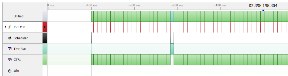
Obrázek 5.3: Proces vypisování dat na displej (z aplikace Segger SystemView)
