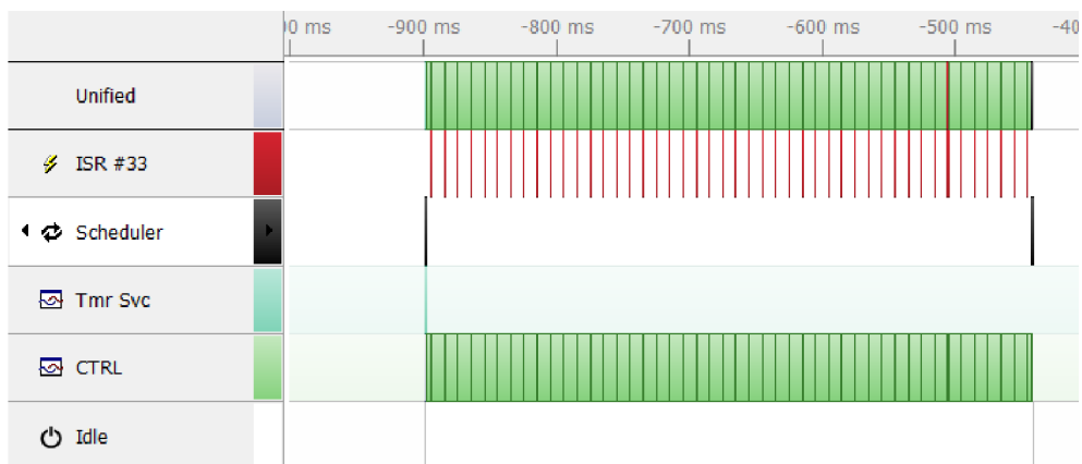
Obrázek 5.2: Proces vypisování dat na displej (z aplikace Segger SystemView)
