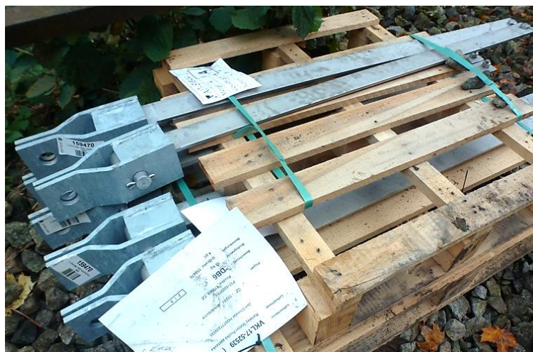
Obr.53 Příklad frikční brzdy, systém Geobrugg (archiv autora)
