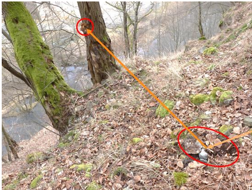
Obr.24 Stanovení odrazivosti a odskoku, přírodní rezervace Prudká (archiv autora)
