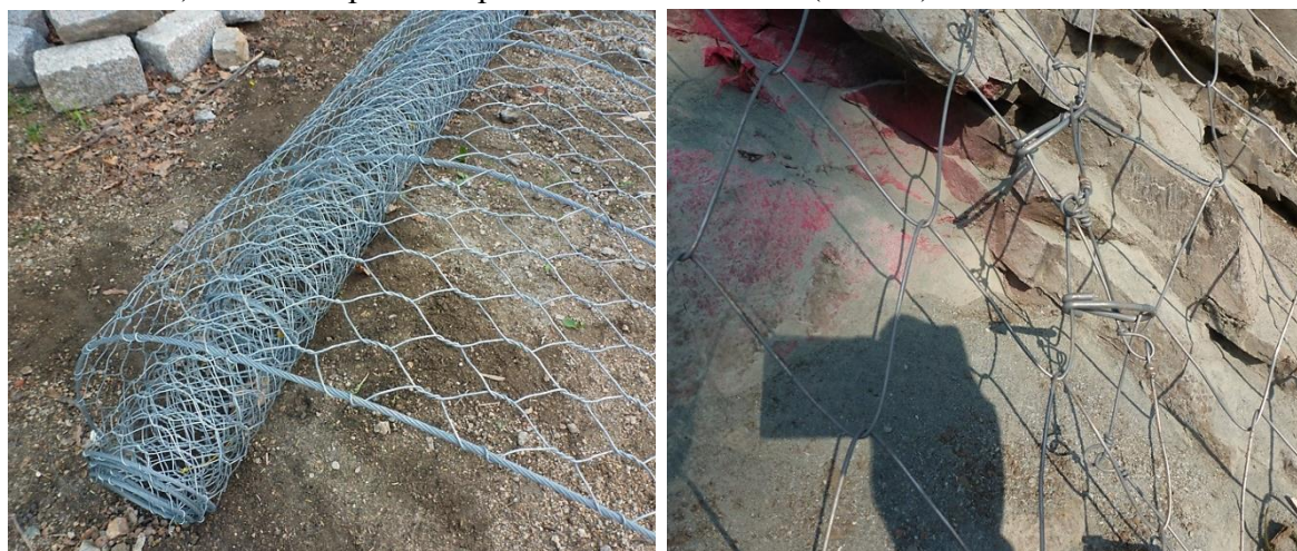
Obr.79 Hexagonální síť s dvojitým zákrutem (vlevo) a ortogonální síť (vpravo) (archiv autora)
