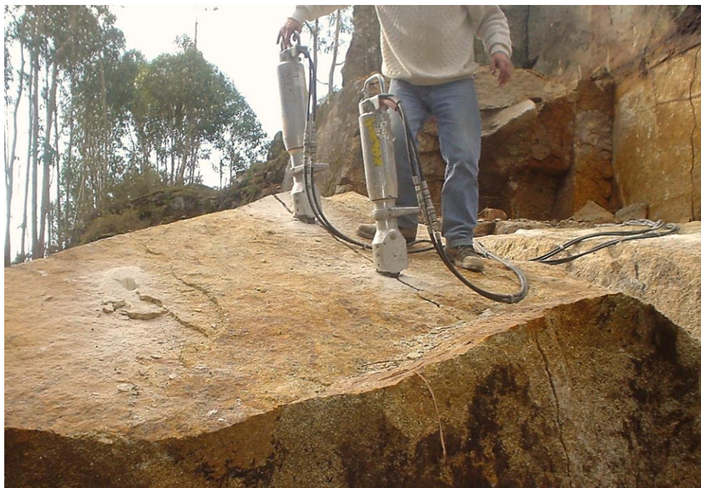
Obr.66 Hydraulické trhací klíny v sérii s tlakem 350 tun (upraveno podle www.darda.de )
