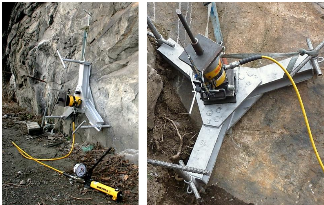
Obr.88 ENERPAC 600 a zatěžovací stend, vpravo detail (archiv autora)
