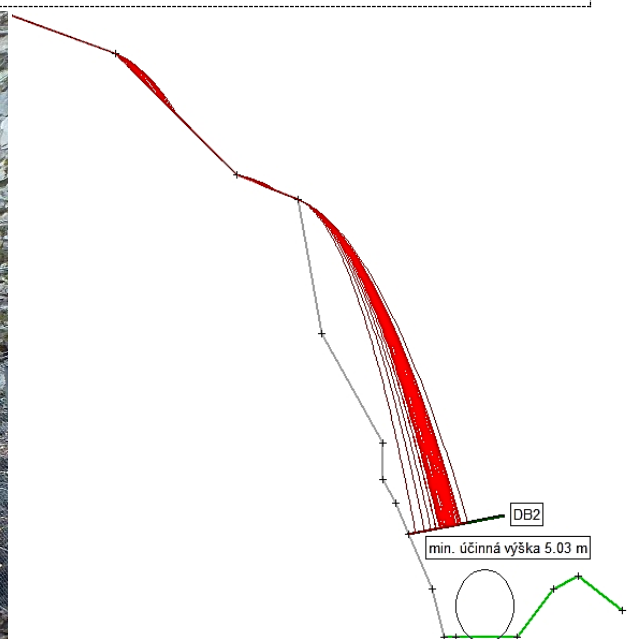
Obr.23 Doubravnický tunel v km 85,200; kinematická simulace pádu bloku o objemu 1,6 \text{ m}^3 bítešské ortoruly pomocí RocFall v.4 (archiv autora)
