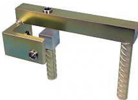
Obr.35 3-D dilatometr (zdroj www.huddy.cz)
