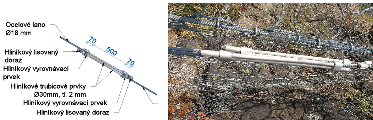
Obr.54 Příklad deformační brzdy, systém Maccaferri (archiv autora)
