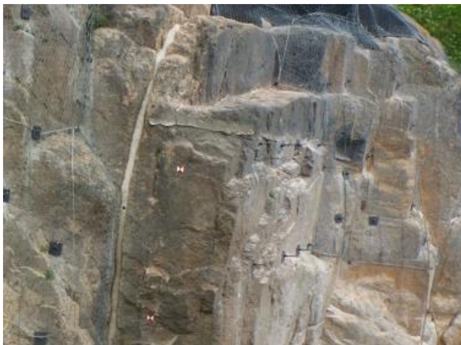
Obr.70 Subvertikální vyspárování pukliny v liberecké žule, ul. Dr. M. Horákové (archiv autora)
