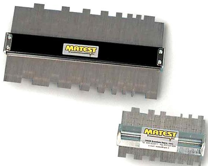
Obr.6 Bartonův profilometr (zdroj: www.matest.com)
