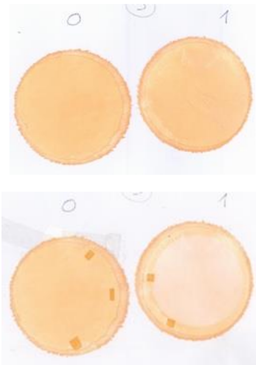
Obrázek 31: Vzorek 3 před ozářením UV lampou (nahore) a po 2. ozáření UV lampou (dole)
