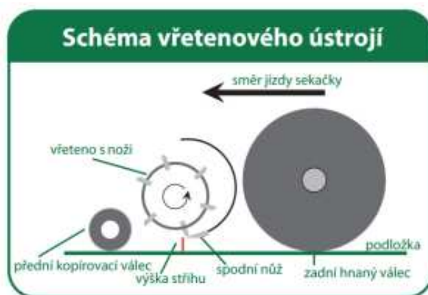
Obrázek 2 Vřetenové ústrojí žacího stroje
