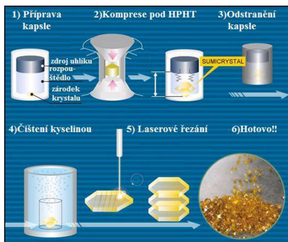
Obr. 2.2 Výrobní proces monokrystalu diamantu "SUMICRYSTAL" [25]
