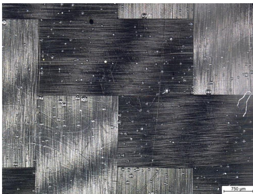
Obrázek č. 30: Uhlíková vlákna ve struktuře lakovaného kompozitu č. 3
