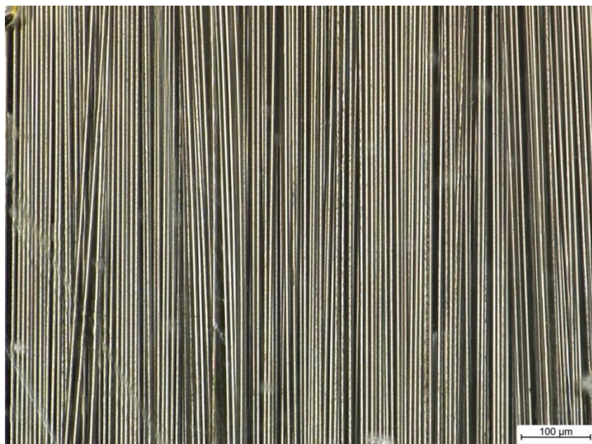
Obrázek č. 36: Degradace vláken nelakovaného kompozitu č. 2
