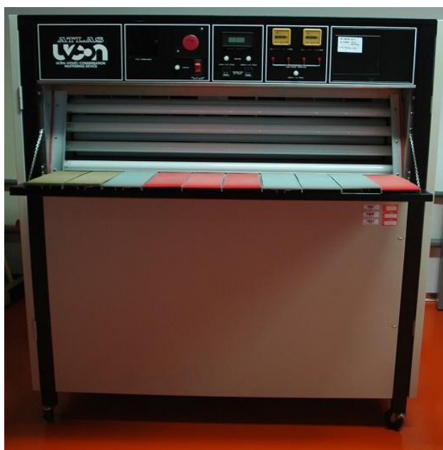
Obrázek č. 17: Zkušební přístroj Atlas UVCON
