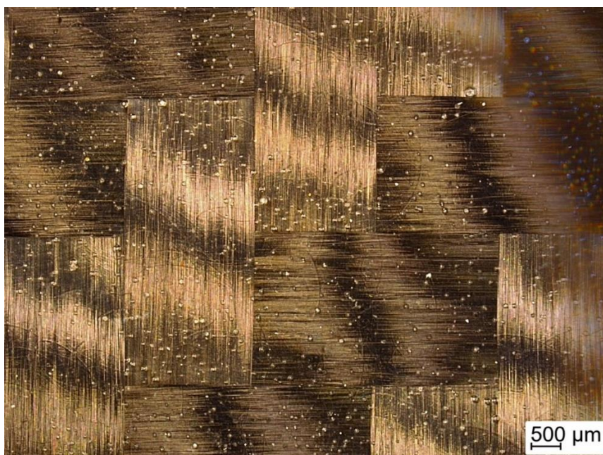
Obrázek č. 4: Uhlíková vlákna ve struktuře kompozitu s lakovou úpravou
