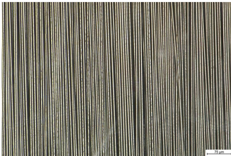
Obrázek č. 34: Degradace vláken nelakovaného kompozitu č. 1
