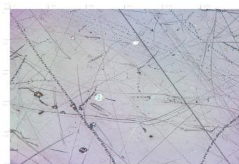
Obrázek č. 10: Povrch nelakovaného kompozitu
