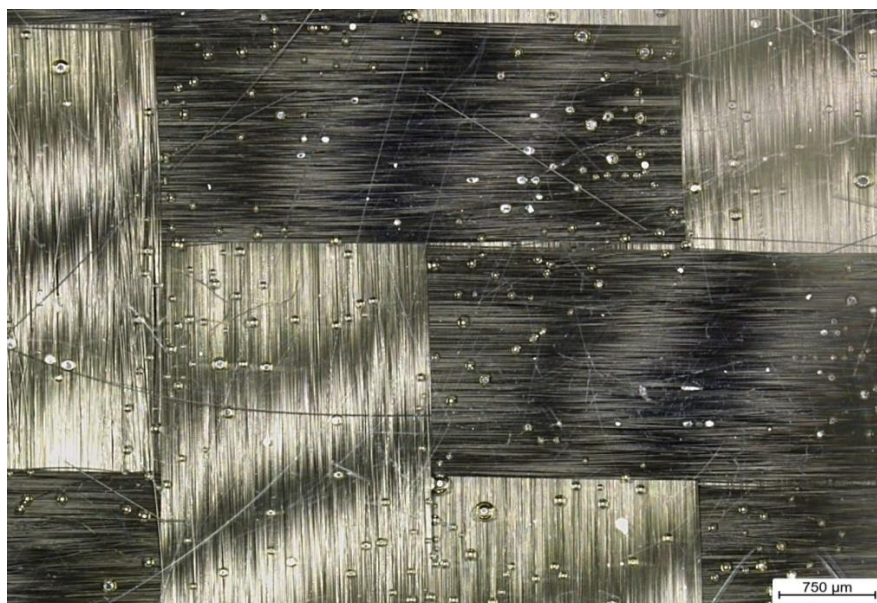
Obrázek č. 33: Uhlíková vlákna ve struktuře nelakovaného kompozitu č. 1
