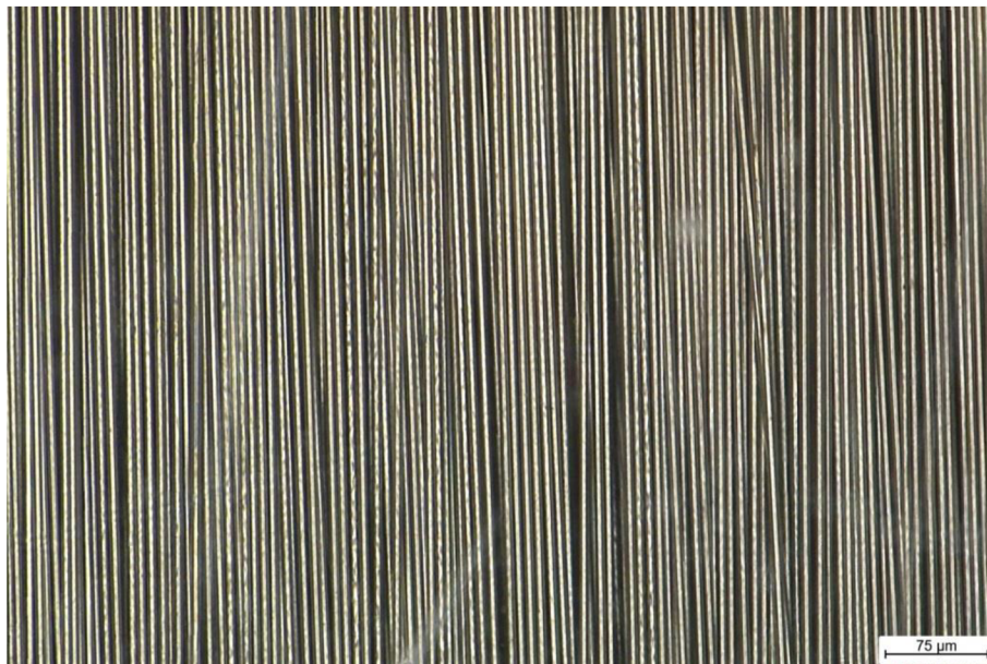
Obrázek č. 34: Degradace vláken nelakovaného kompozitu č. 1
