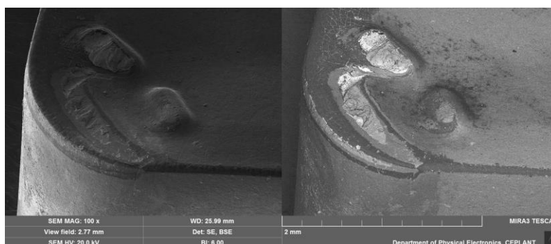
Obrázek 63. Nepravidelné opotřebení utvařečů třísek ( t = 4,25 min) [67].
