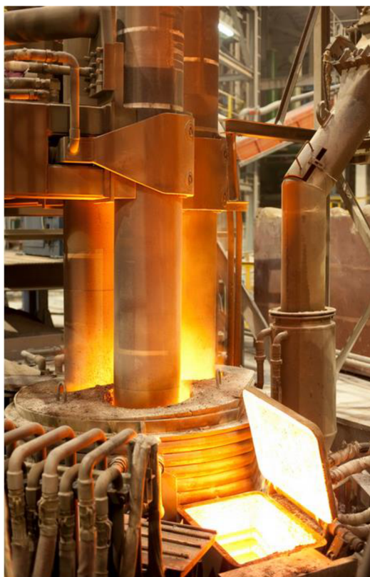
Obr. č. 7: Grafitové elektrody a otevřená dvířka pánvové pece [10]
