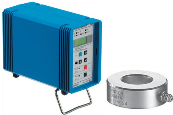
Obr. 25 Aparatura Kistler – měření axiální síly. (15)(16)
