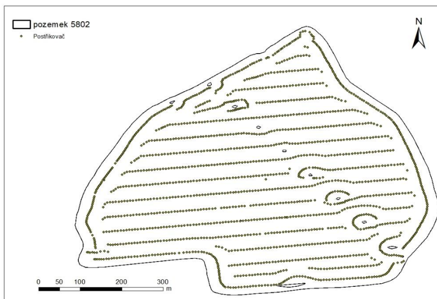
Obrázek 31: Grafické zobrazení jízdni trajektorie postřikovače při aplikaci chemické ochrany (zdroj vlastní)
