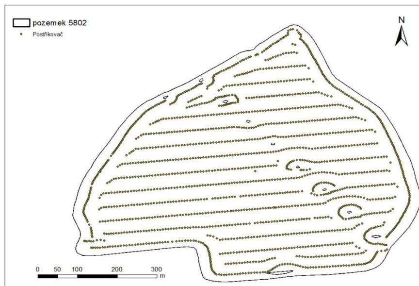
Obrázek 31: Grafické zobrazení jízdní trajektorie postřikovače při aplikaci chemické ochrany (zdroj vlastní)
