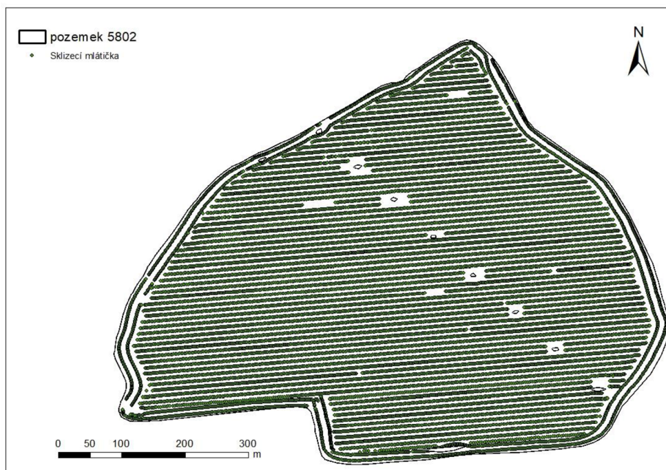
Obrázek 24: Zobrazení trajektorie jízdy sklízecí mlátičky (zdroj vlastní)
