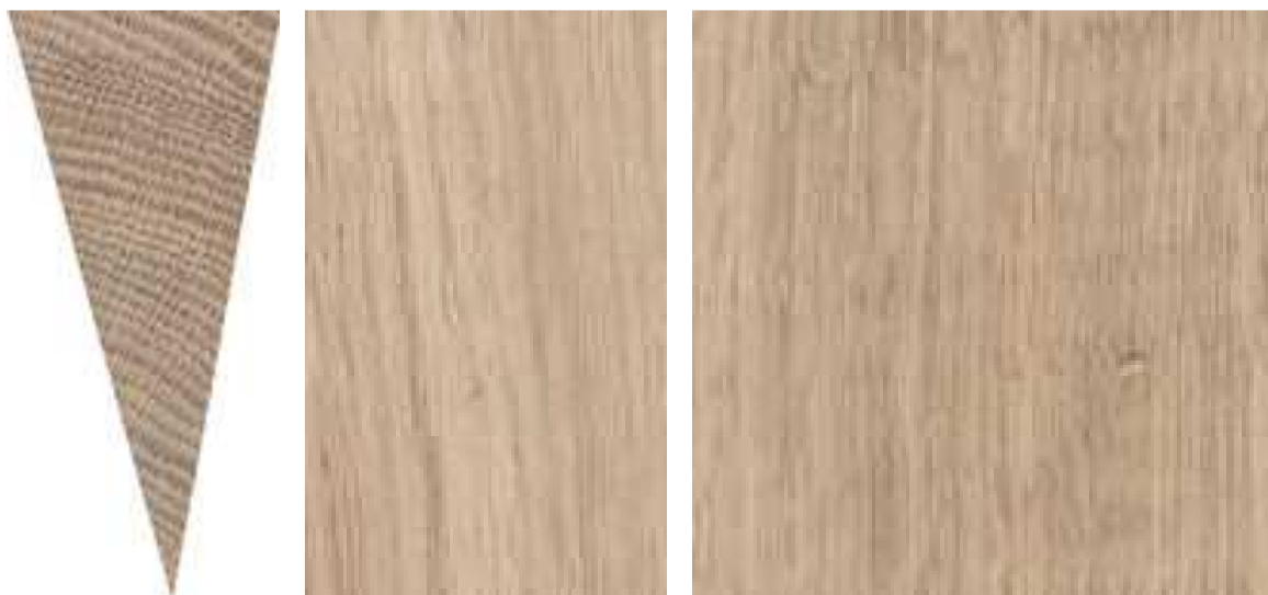
Obr. 4: Příčný, tangenciální a radiální řez dřevem dubu (Vavrčík, 2002)
