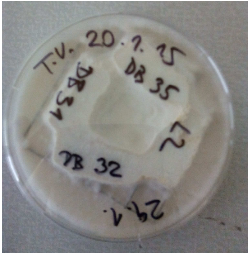
Obr. 9: Vzorky s houbou outkovkou pestrou v Petriho misce
