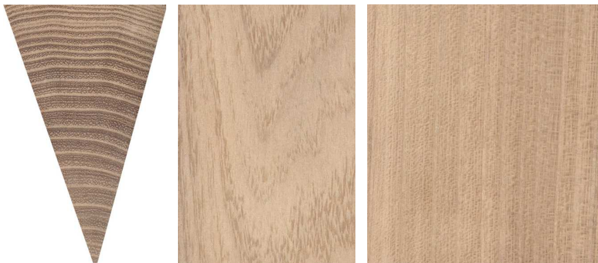
Obr. 3: Příčný, tangenciální a radiální řez dřevem akátu (Vavřík, 2002)
