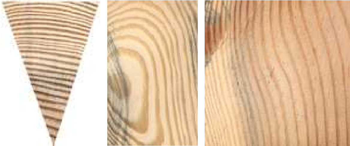
Obr. 6: Příčný, tangenciální a radiální řez dřevem borovice (Vavrčík, 2002)
