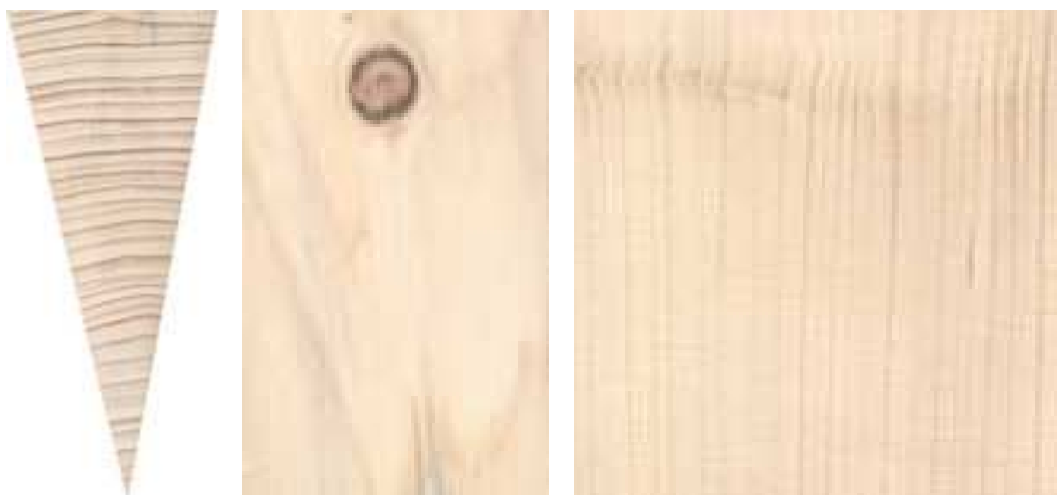
Obr. 5: Příčný, tangenciální a radiální řez dřevem smrku (Vavrčík, 2002)
