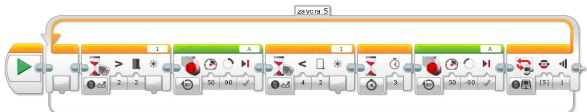
Obr. 35 Návrh programu automatické závoru se světelným senzorem
