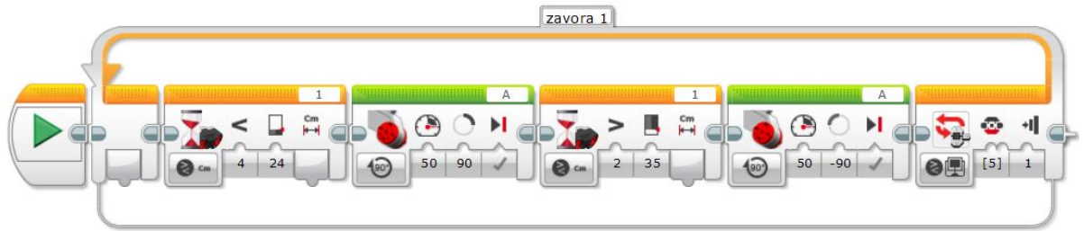
Obr. 32 Návrh programu s hlídáním prostoru před a pod závorou
