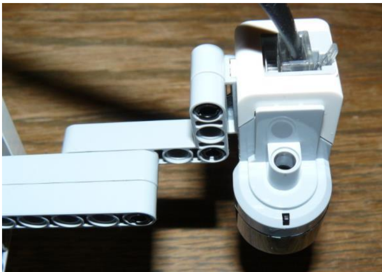
Obr. 1-6 Detail připojení ultrazvukového senzoru
