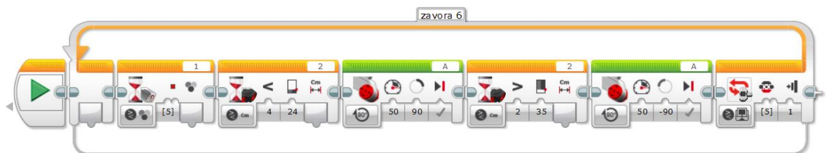
Obr. 37 Návrh programu automatické závory s ultrazvukovým senzorem doplněný o hlídání barevného označení automobilu
