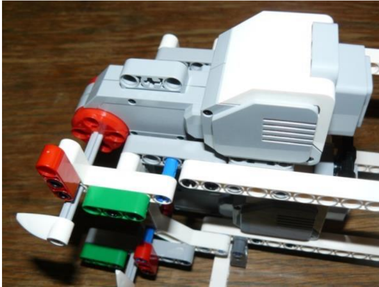
Obr. 1-5 Detail připojení napouštěcího ventilu
