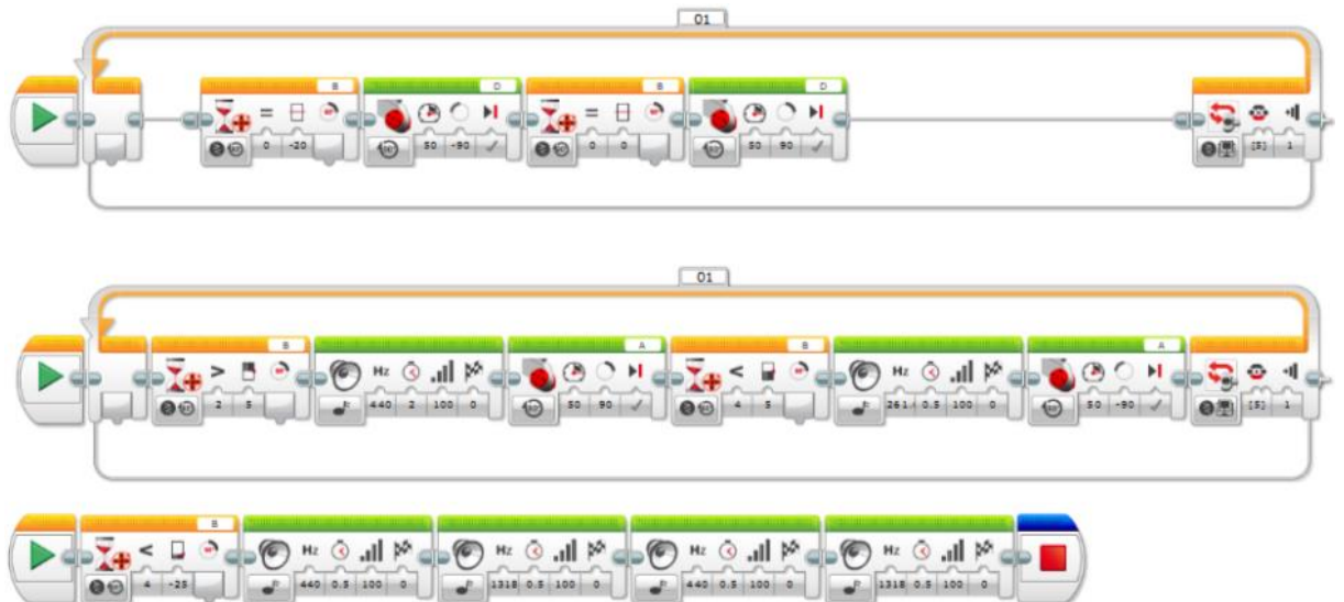
Obr. 1-16 Návrh programu pro automatickou regulaci pomocí interaktivního servomotoru ve funkci rotačního senzoru s řešením poruchových stavů
