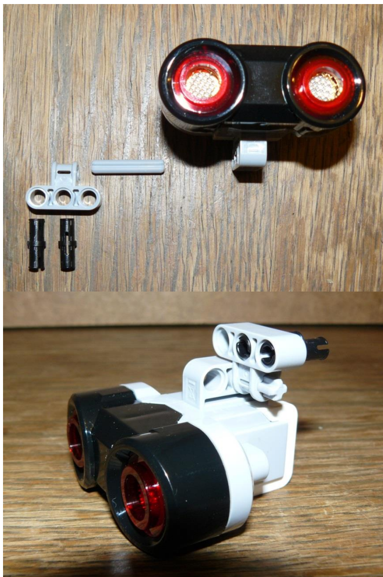
Obr. 2-3 Detail montáže ultrazvukového senzoru
