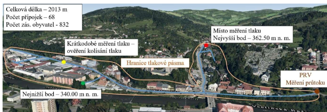
Obr 4.6 Charakteristika zástavby a topologie sítě předmětného tlakového pásma
