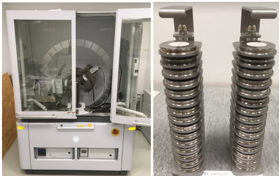
Obrázek 26 - Zařízení XRD PANalytical Empyrean, Cu – katoda \lambda = 1,540598 pro záření K\alpha_1 (vlevo) připravené vzorky v nosiči pro vyhodnocení v zařízení XRD PANalytical Empyrean (vpravo)
