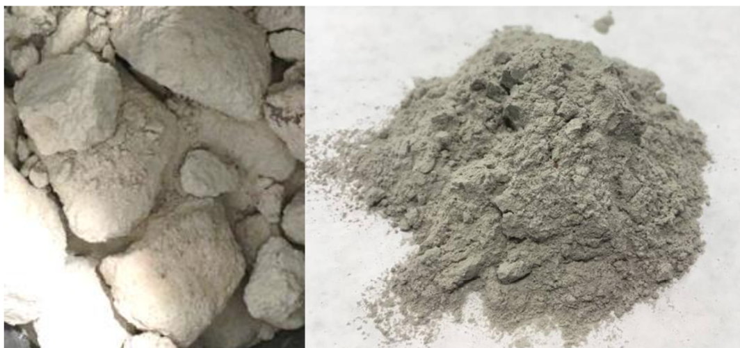
Obrázek 29 - Vyzdívka Silica – neupraveno (vlevo), upravená vyzdívka Silica v kulovém mlýnu měrný povrch 268 \text{ m}^2 \cdot \text{kg}^{-1} (vpravo)
