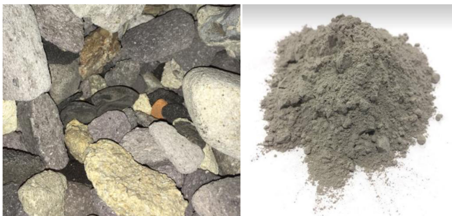
Obrázek 28 - Šamotové valounky – neupraveno (vlevo), upravené šamotové valounky v kulovém mlýnu měrný povrch 253 m 2 ·kg -1 (vpravo)
