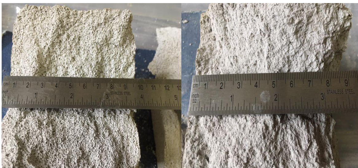
Obrázek 42 - Vzhled makropórovité struktury vzorků pórobetonu. Vlevo vzorek ZAV (REF), vpravo vzorek SILI 50 - zborcená struktura
