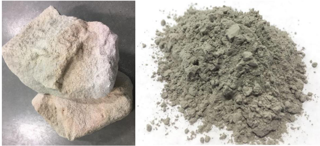
Obrázek 30 – Slévárenský písek – neupraveno (vlevo), upravený slévárenský písek v kulovém mlýnu měrný povrch 261 \text{ m}^2 \cdot \text{kg}^{-1} (vpravo)
