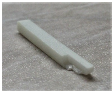
Obrázek 3.16: Ukázka separace vrstev po tříbodovém ohybu
