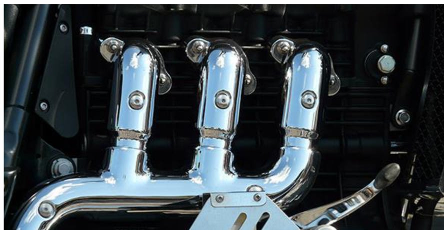
Obr. 11 Výfukový systém z korozivzdorné oceli [15]
