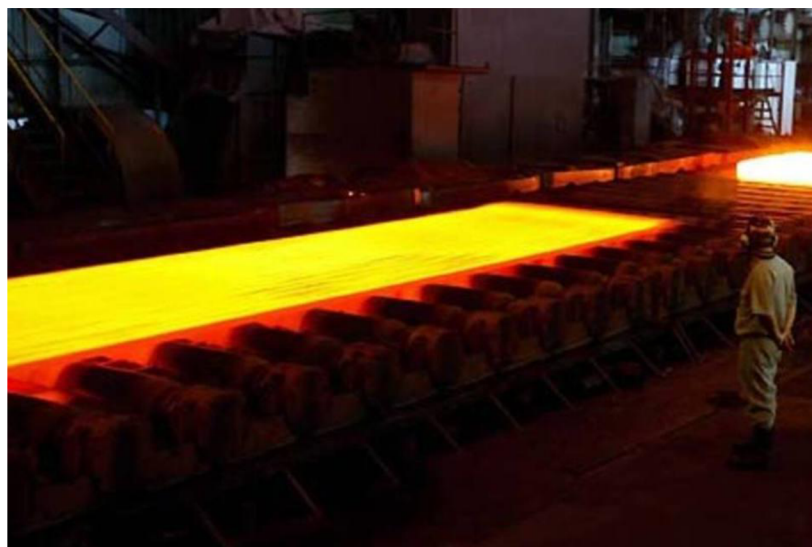
Obr. 17 Polotovary vyjíždějící z válcovací trati [23]
