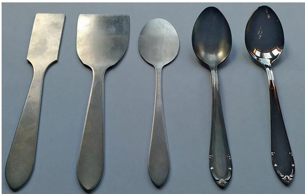
Obr. 20 Lžice v různých fázích výroby [26]
