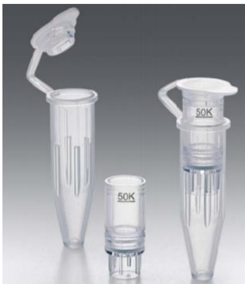
Obrázek 7: Mikrozkuhavka s filtrem pro in-solution štěpení metodou FASP. Převzato z www.sartorius.com
