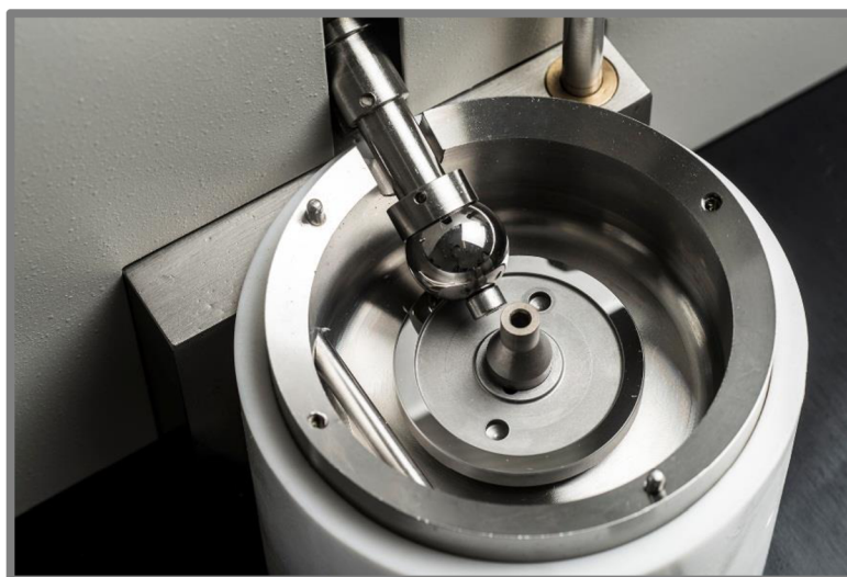
Obr. 13 Testovací zařízení MTM [21]
