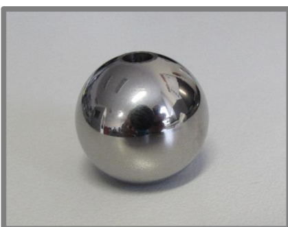
Obr. 18 Kulička ze slitiny CoCrMo
