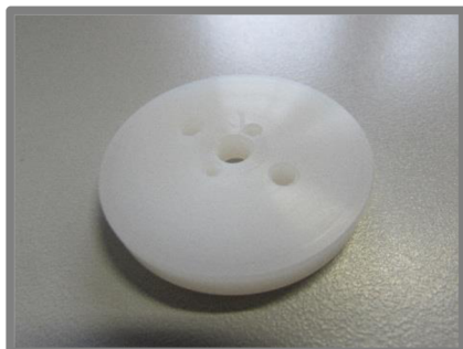
Obr. 17 Disk z vysoce zesíťovaného polyetylenu
