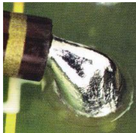
Obr. 23.: Pájka v ohybu vývodu – nesmí nastat [10]
