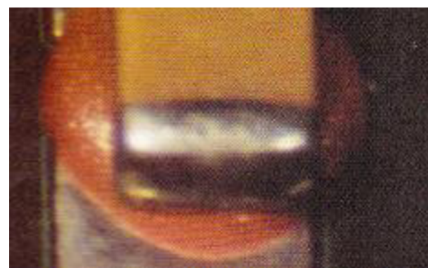
Obr. 41.: Adhezivum pod vývodem součástky – nesmí nastat [10]
