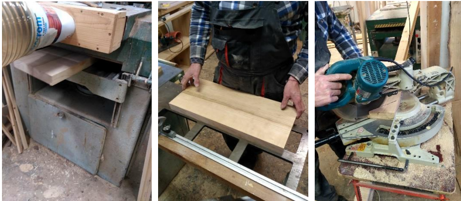
Obrázek 41 Upravování velikosti na formátovací pile (zdroj: autor)
