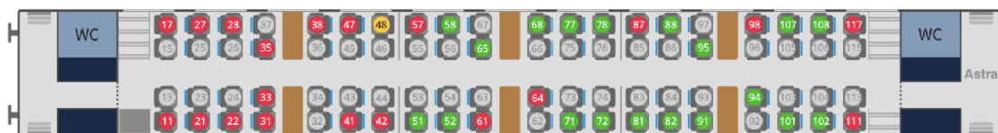
Obrázek 13: Plánek uspořádání velkoprostorového vozu Bmpz 20 – 90 používaný jako cestovní třída Standard ASTRA
