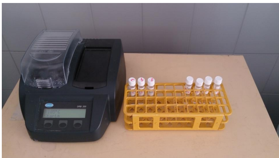
Termoreaktor HACH DRB 200 s připravenými vialkami pro stanovení celkového dusíku
