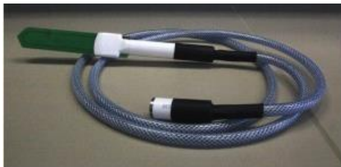
Obrázek 4 Senzor TMS-4 s kabelem (Wild a kol. 2019)
