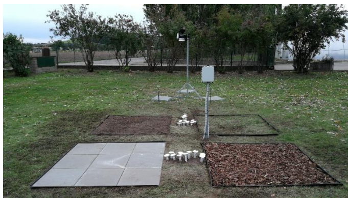
Obrázek 6 Senzory instalované na experimentální lokalitě (autor Miroslav Fér)
