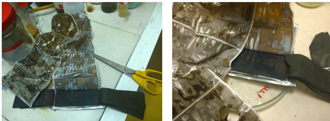
Obrázek 17: Rozebírání reálné baterie KOKAM
