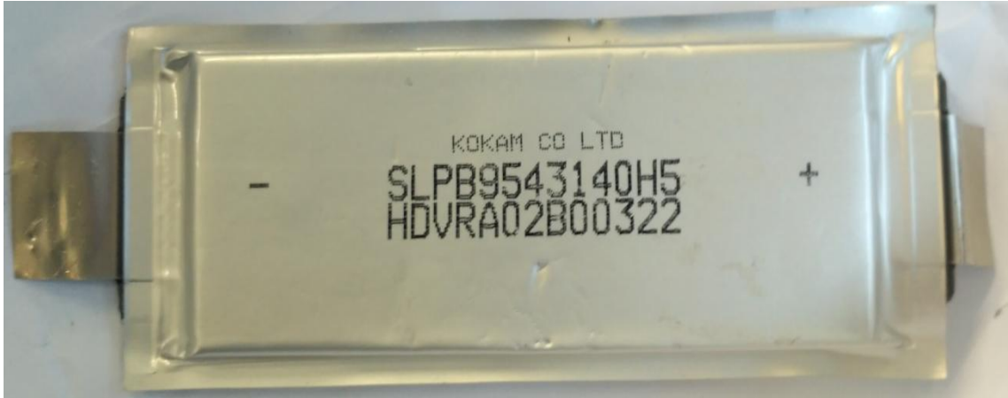
Obrázek 19: Reálná geometrie testované baterie
