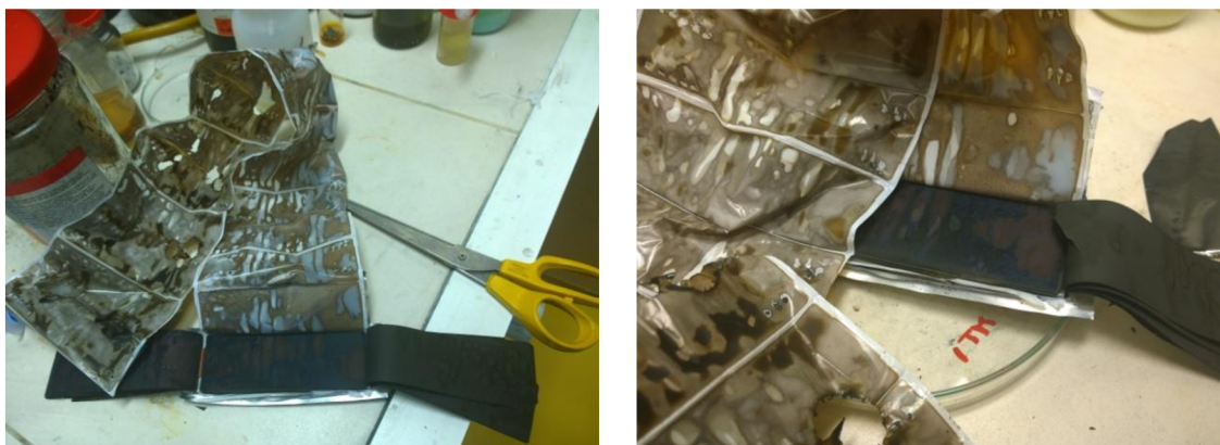
Obrázek 17: Rozebírání reálné baterie KOKAM
