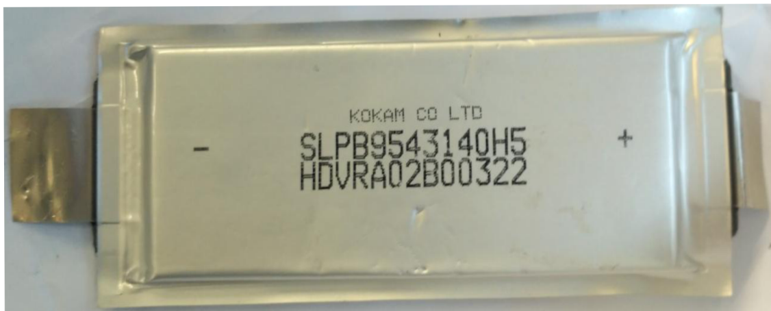
Obrázek 19: Reálná geometrie testované baterie
