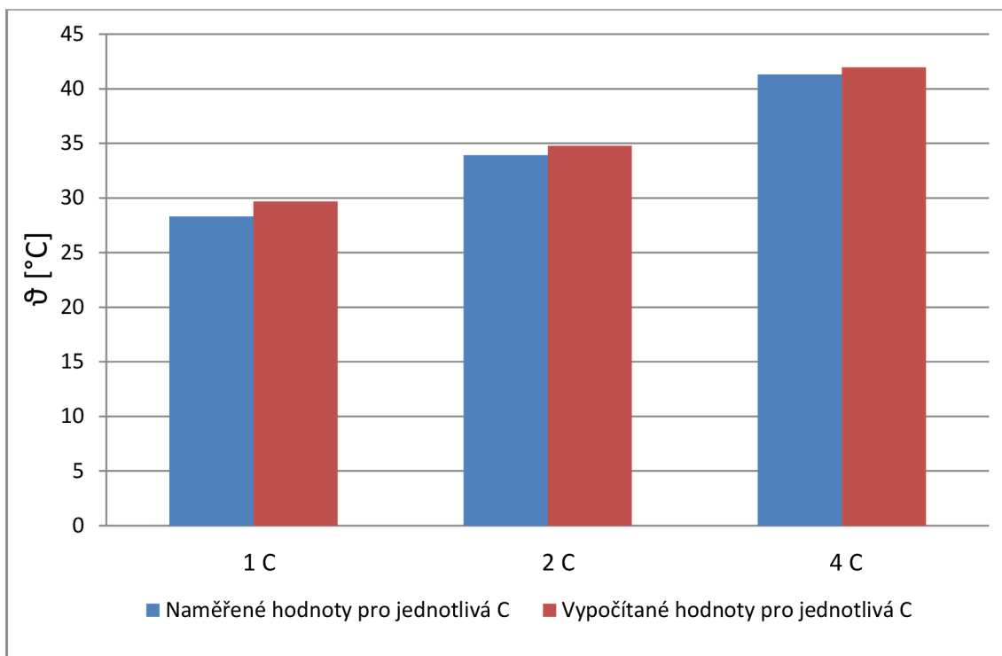
Obrázek 45: Porovnání naměřených a nasimulovaných teplot během vybíjení pro různá C
