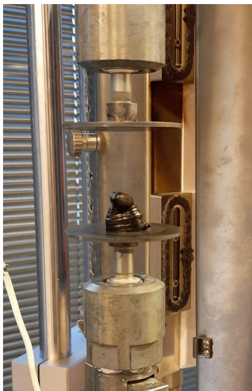
Obr.49 přípravek s lepidlem v čelistech stroje
