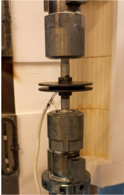
Obr.51 umístění termočlánu na spodní desku
