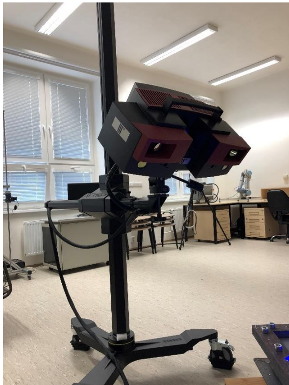
Obr.31 ATOS III TripleScan na mobilním stativu
