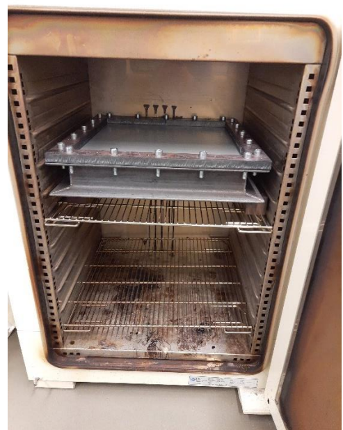
Obr.36 vložení přípravku do pece
