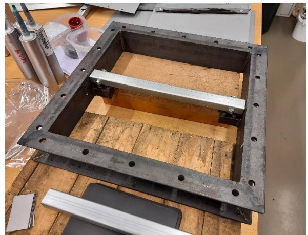
Obr.23 vložení a připevnění plechového U profilu
