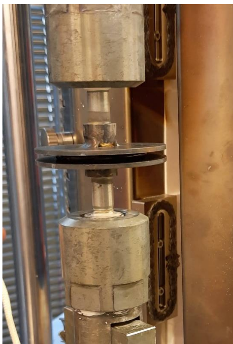
Obr.50 přiblížení desek na požadovanou vzdálenost
