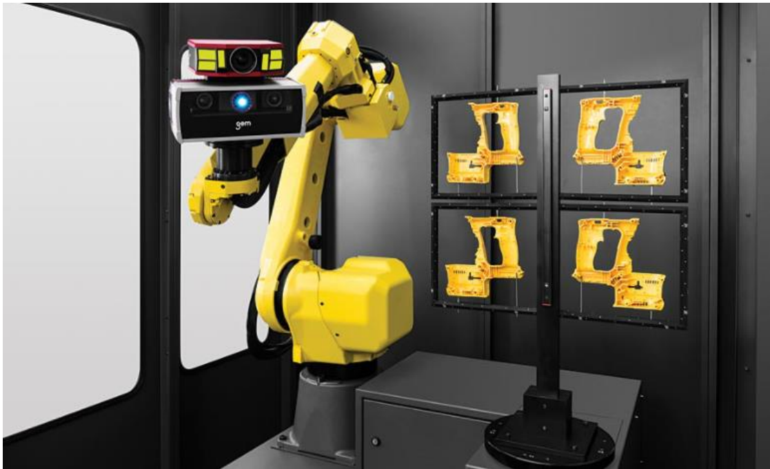
Obr.10 skener na robotické paži [20]
