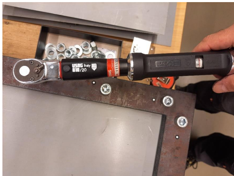
Obr.29 utahení šroubů na požadovaný utahovací moment
