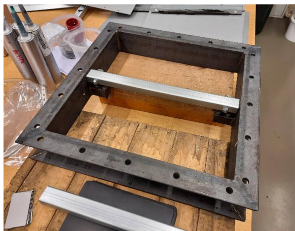
Obr.23 vložení a připevnění plechového U profilu
