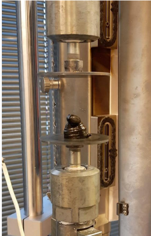
Obr.49 přípravek s lepidlem v čelistech stroje
