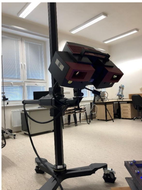
Obr.31 ATOS III TripleScan na mobilním stativu
