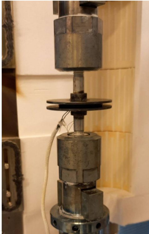
Obr.51 umístění termočláneku na spodní desku
