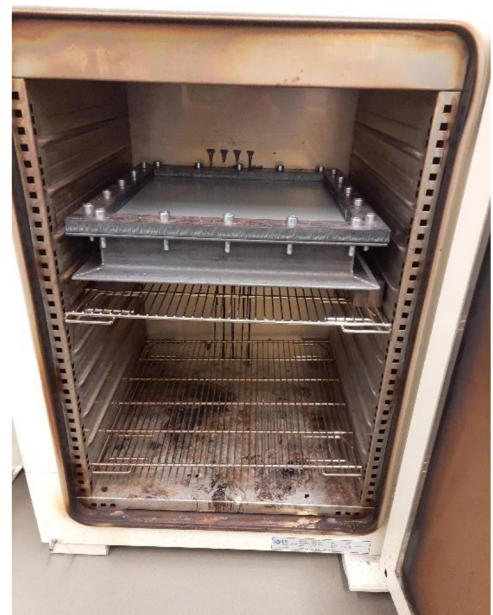
Obr.36 vložení přípravku do pece
