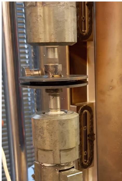
Obr.50 přiblížení desek na požadovanou vzdálenost
