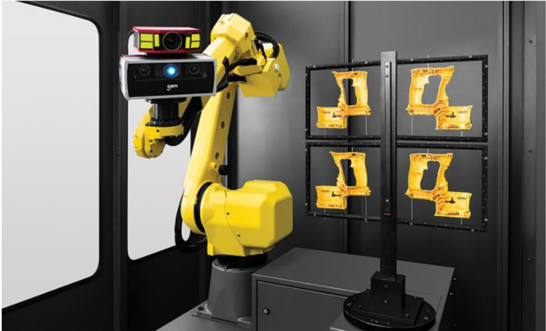
Obr.10 skener na robotické paži [20]
