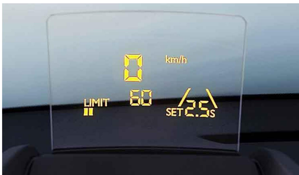
Obr. 14 Zobrazení na polykarbonátovou destičku [5]
