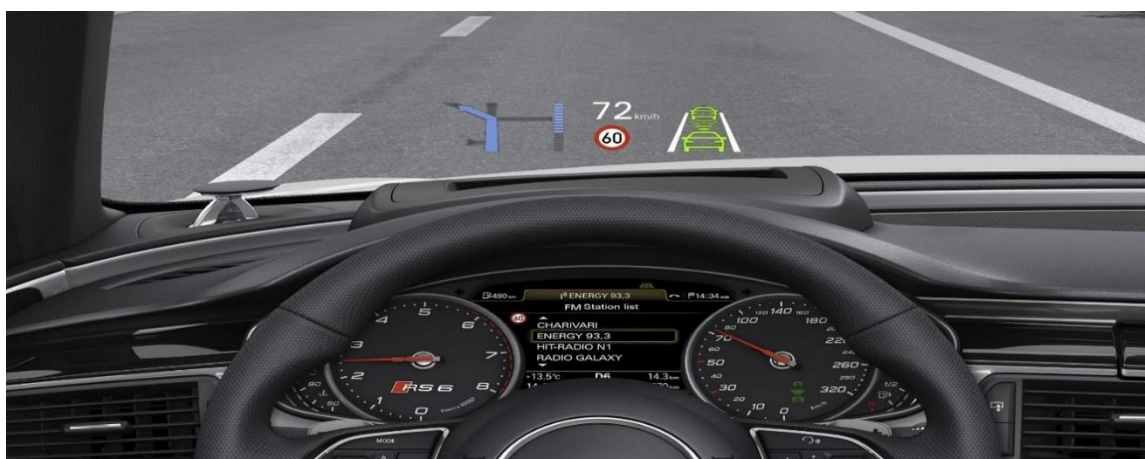
Obr. 10 Zobrazení HUD u AUDI A6 [23]
