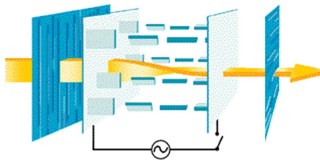
Obr. 5 Základní stav TFT krystalu – bez procházejícího napětí [12]
