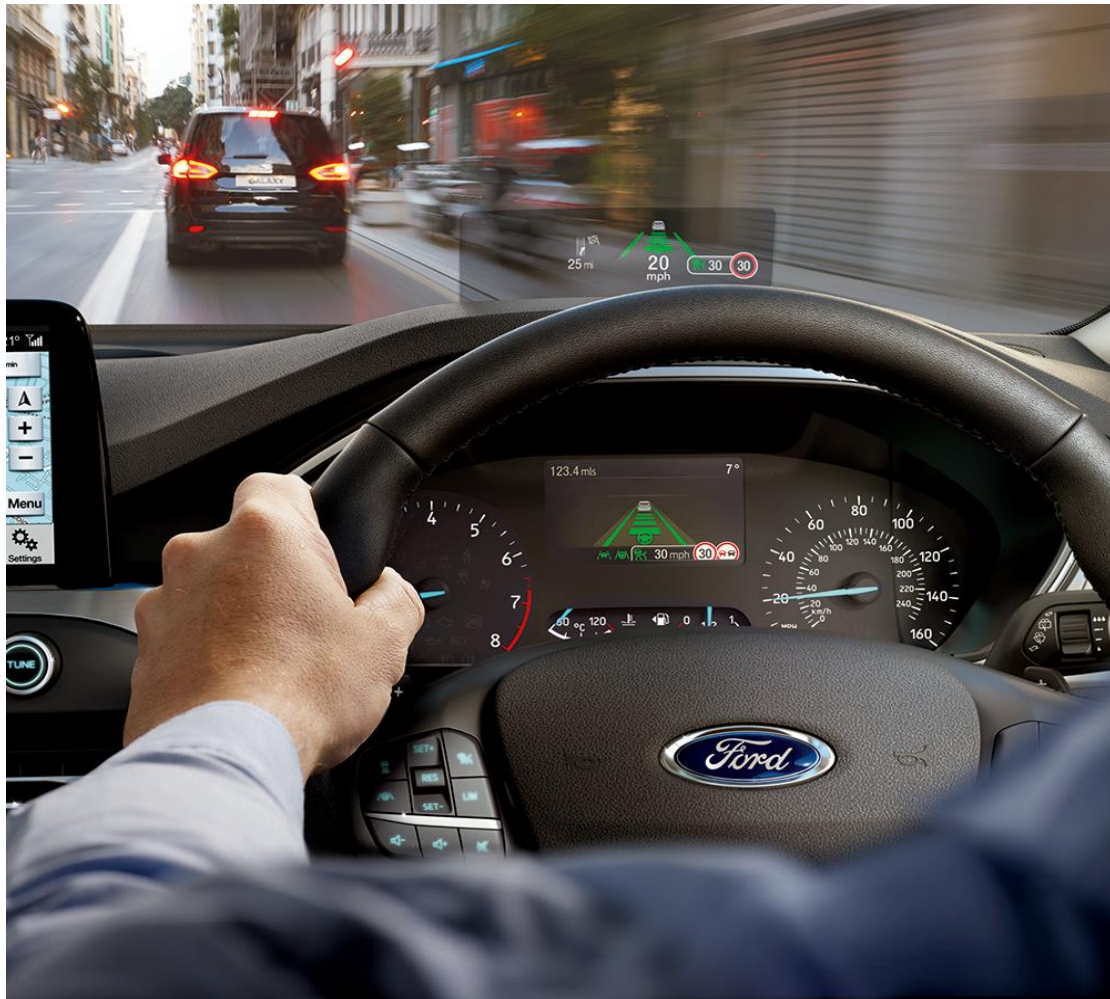
Obr. 15 Zobrazení HUD u Fordu Focus [30]
