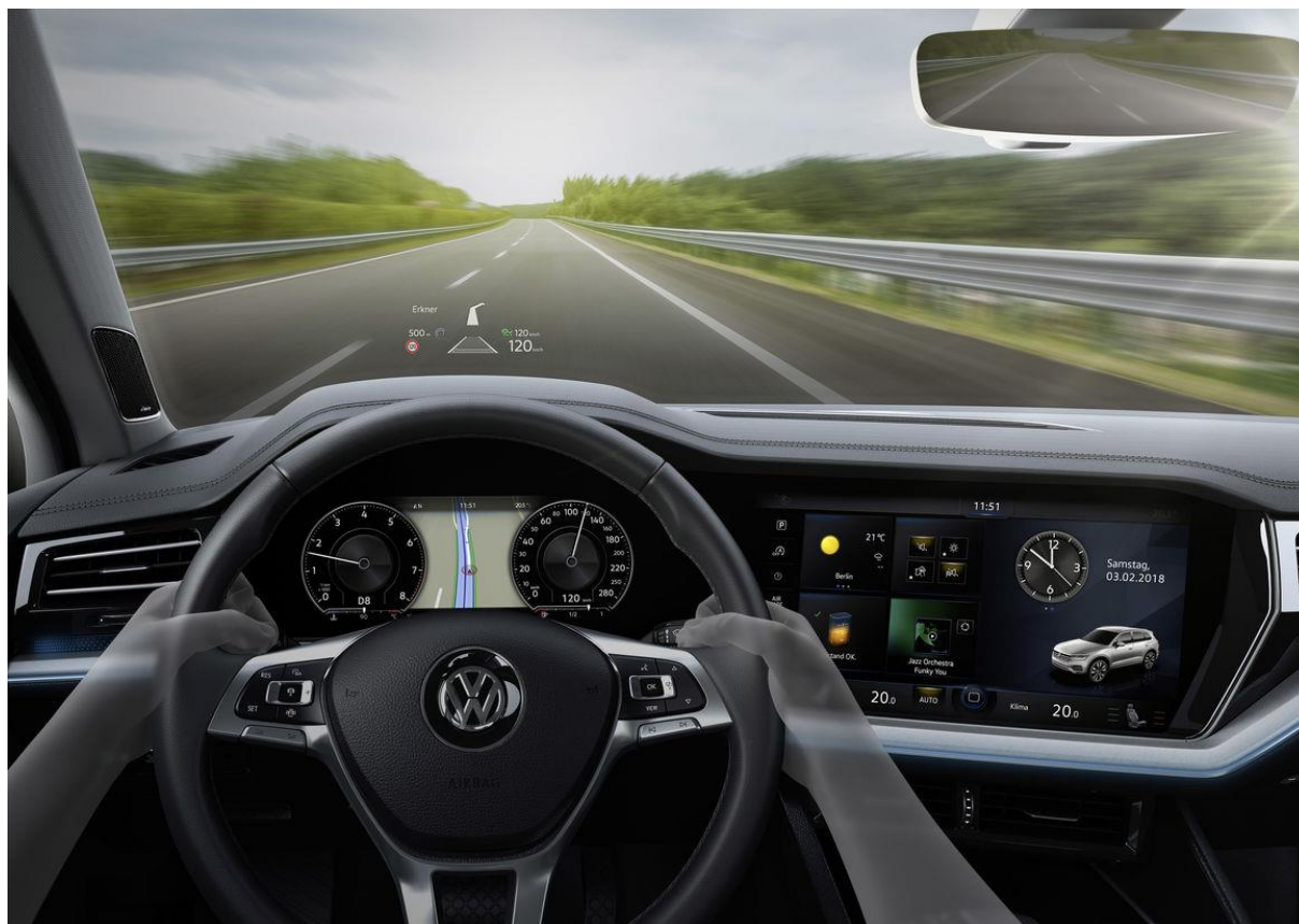
Obr. 12 Zobrazení HUD u VW [27]
