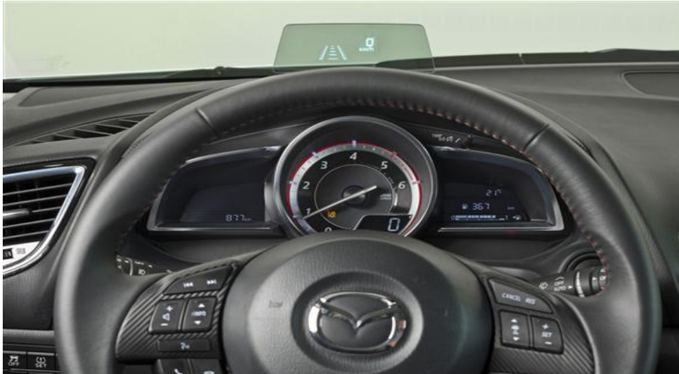
Obr 16. Zobrazení na polykarbonátovou destičku u vozu Mazda 3 [19]
