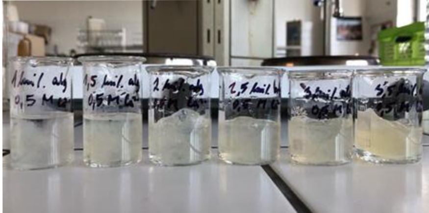
Příloha 4: Koncentrační řada alginátových hydrogelů s 0,5\text{ M CaCl}_2 \cdot 2\text{H}_2\text{O} v poměru 2:1.
