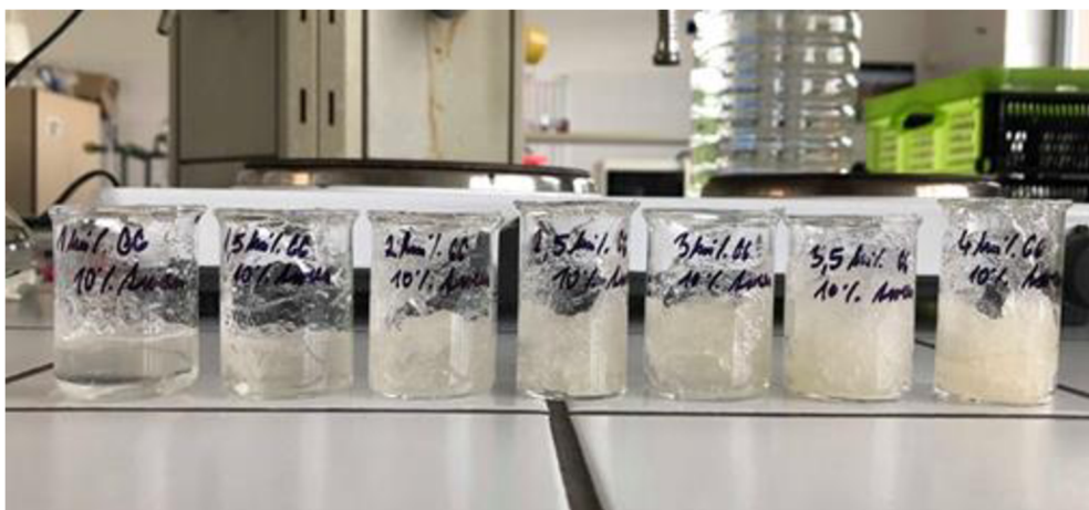
Příloha 2: Koncentrační řada gellanových hydrogelů s 10 obj. % tweenem 80.
