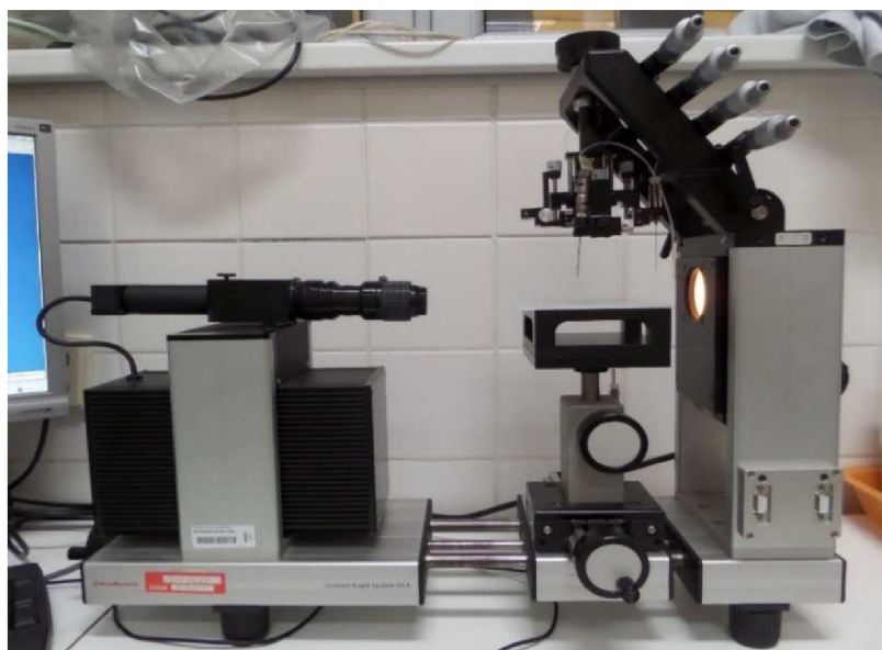
Obr. 41: Prístroj Dataphysics OCA 20 použitý na meranie kontaktného uhlu
