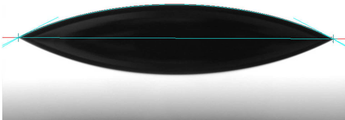
Obr. 42: Určenie kontaktného uhlu graficky
