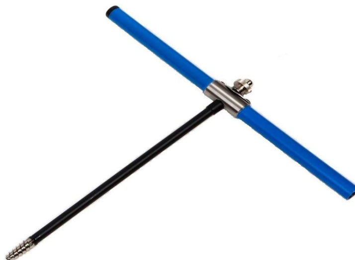
obr. 5 – Presslerův přírůstkový nebozeze (www.naturfun.pt)
