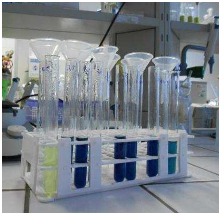
Obr. 9. Zkumavky po povaření a ochlazení, které obsahují 0,5 ml reakční směsi (CMC a volný enzym), 0,5 ml směsi Somogyi-Nelsonova činidla I a II, 0,5 ml Somogyi-Nelsonova činidla III a 3,5 ml destilované vody
