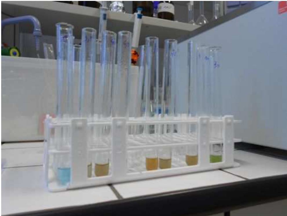
Obr. 8. Zkumavky po povaření, které obsahují 0,5 ml reakční směsi (CMC a volný enzym) a 0,5 ml směsi Somogyi-Nelsonova činidla I a II
