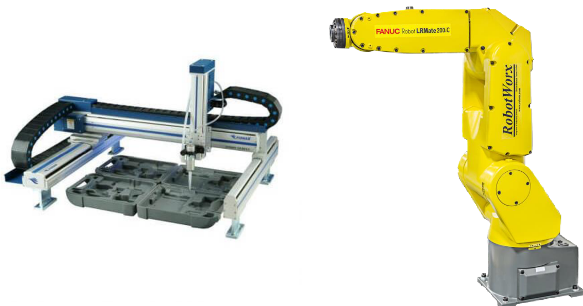
Obr. 22) a) Kartézský robot [43], b) Šestiosý robot [44]
