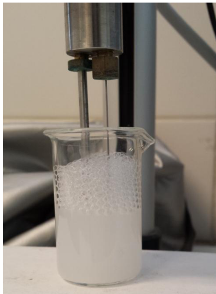
Obr. 13: Měřicí systém pro tenziometrické měření maximálního přetlaku v bublině.
